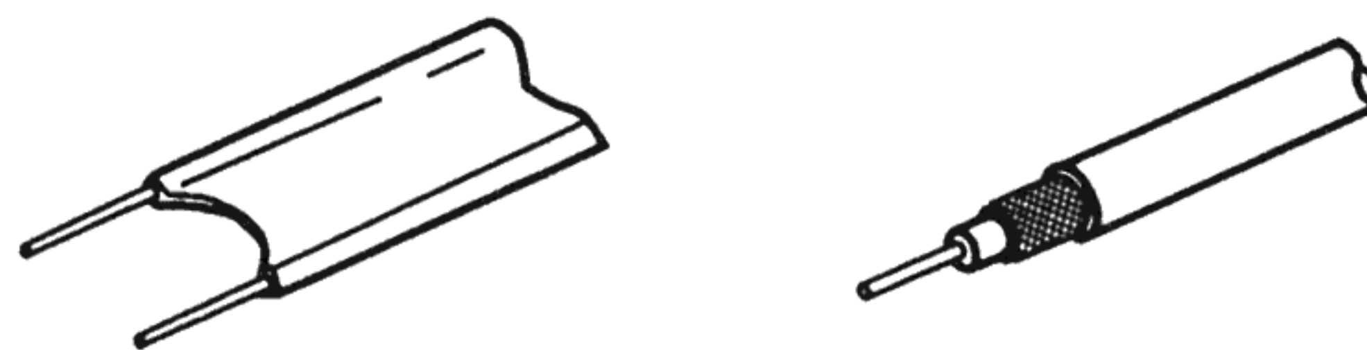
voedingskabel van 300 Ω/ohm coaxiale kabel van 75 Ω/ohm
