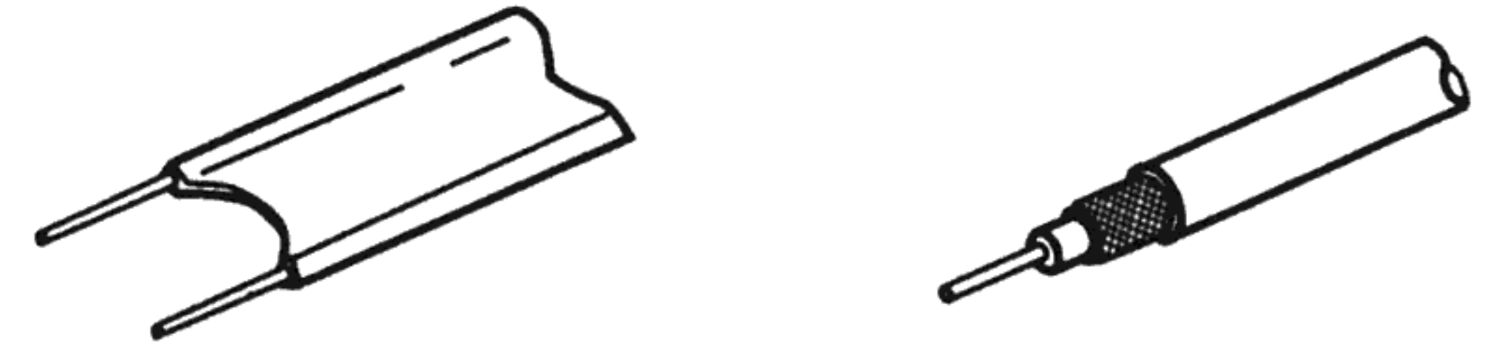
Cabo de alimentação de 300 Ω/ohms Cabo coaxial de 75 Ω/ohms
